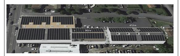
Initialement, l'entreprise proposait 120 000 €HT pour le remplacement des toitures amiantées par des bacs acier. Le coût sous-estimé ne prenait pas en compte les réfections des chéneaux, la mise en œuvre d'une toiture isolée, le remplacement des trappes de désenfumage nécessaires à l'obtention du classement ERP du bâtiment pour son activité projetée.
